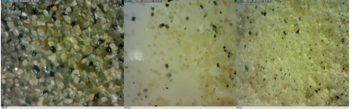
Şekil 34. Çubuklu Değirmen mikroskop görüntüleri (+45 mikron)
