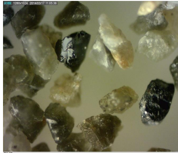
Şekil 16. Bilyalı değirmen mikroskop görüntüleri (+212 mikron).
