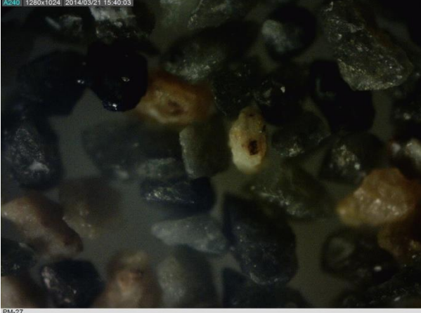
Şekil 28. Çubuklu Değirmen mikroskop görüntüleri (+180 mikron).
