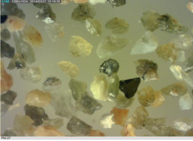
Şekil 19. Bilyalı değirmen mikroskop görüntüleri (+125 mikron).
