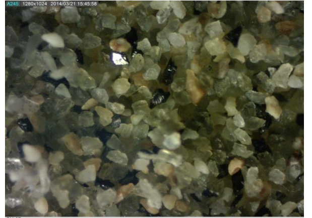
Şekil 33. Çubuklu Değirmen mikroskop görüntüleri (+63 mikron).
