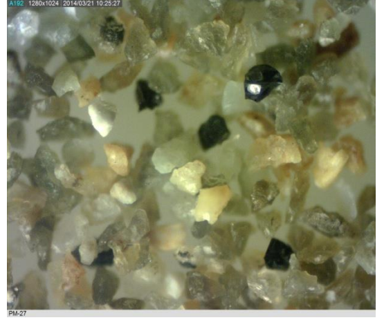
Şekil 20. Bilyalı değirmen mikroskop görüntüleri (+ 106 mikron).
