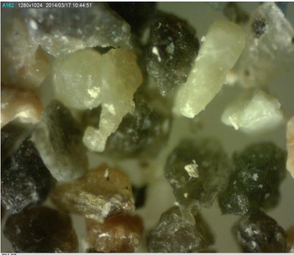
Şekil 15. Bilyalı değirmen mikroskop görüntüleri (+250 mikron).
