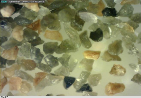
Şekil 30. Çubuklu Değirmen mikroskop görüntüleri (+125 mikron).
