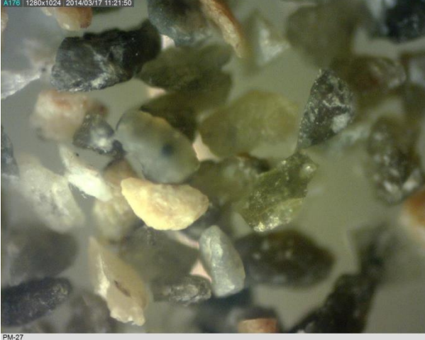
Şekil 17. Bilyalı değirmen mikroskop görüntüleri (+180 mikron).
