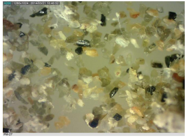
Şekil 22. Bilyalı değirmen mikroskop görüntüleri (+63 mikron).
