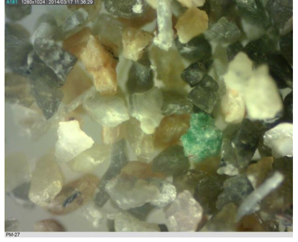
Şekil 18. Bilyalı değirmen mikroskop görüntüleri (+150 mikron).
