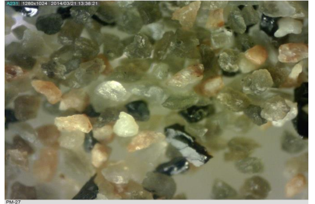
Şekil 31. Çubuklu Değirmen mikroskop görüntüleri (+106 mikron).
