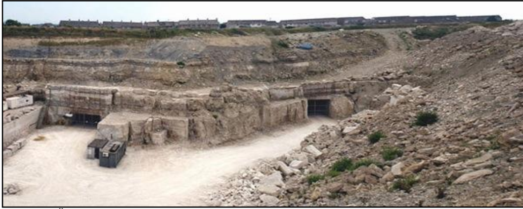
Şekil 1 Örtü tabakasının verimsiz olması ve yer üstünde tesis bulunması durumunda yeraltı işletmeciliğine geçiş (Bowers Mine) (Anon (h) 2007)
