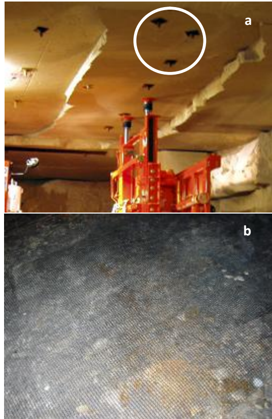
Şekil 26 Yeraltı mermer ocaklarında tavan civatası (a) ve tel hazır (b) uygulaması (a:Anon (g) 2009, b:Carrara-İtalya 2005)
