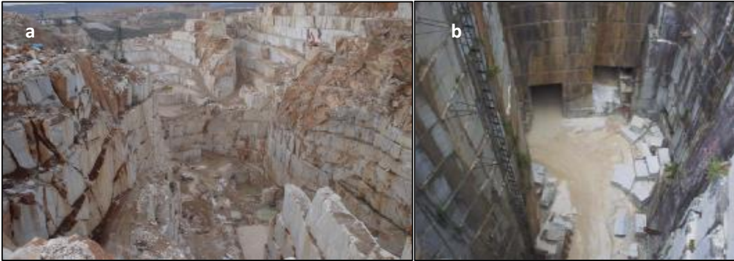
Şekil 2 Düz ocakta derinliğin artmasıyla daralan çalışma alanı (a: İsehisar, Afyonkarahisar, b: Akkoç 2003)
