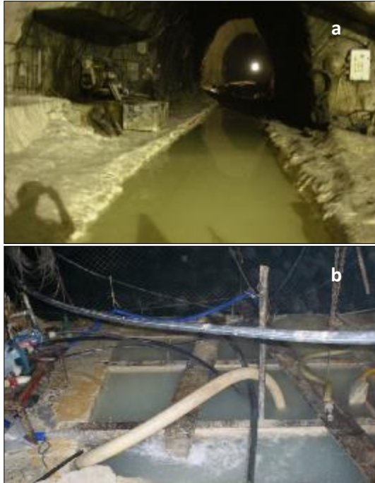
Şekil 24 Yeraltı mermer ocağında su tahliye kanalı (a) ve çöktürme havuzu (b) (Carrara-İtalya 2005)
