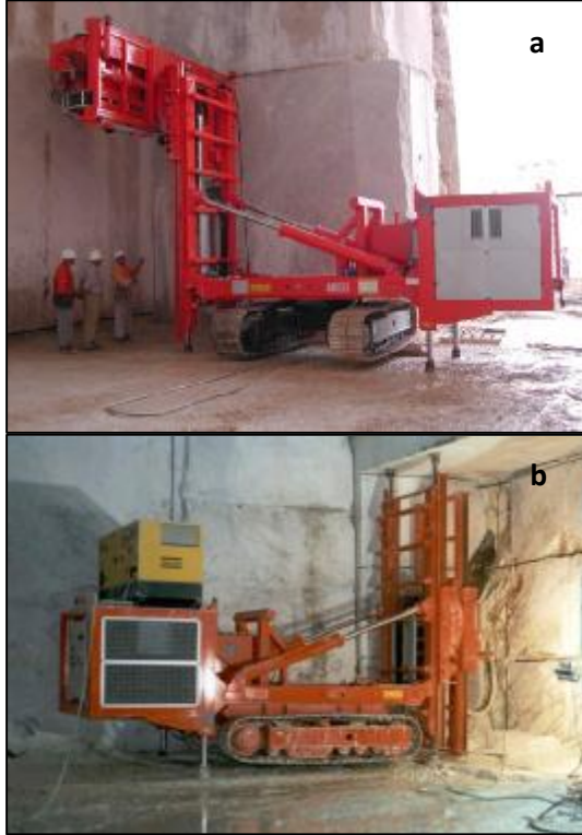
Şekil 8 Mekanize kolları kesme makinasının yatay (a) ve dikey (b) kesim için konumlandırılması (Anon (f) 2009)
